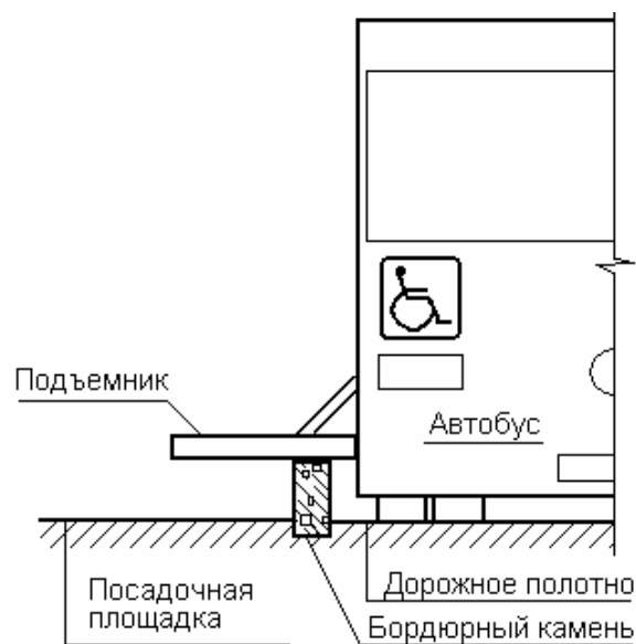
Рисунок 4.9. Схема работы автобуса с подъемником или рампой
