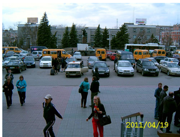
Рисунок 3.15. На посадочных площадках остановок не обеспечены пути передвижения маломобильных граждан
